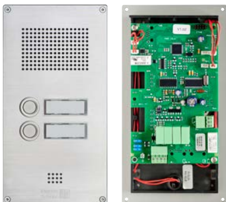
Vue de face d'un portier téléphonique série 5 et vue de l'électronique
