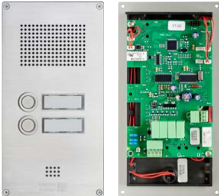
Frontansicht einer Türstation der Serie 5 und Sicht auf die Elektronik
